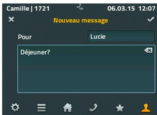
Pour écrire le message vous disposez à nouveau du clavier complet. Pour envoyer le message, il suffit d'effleurer le crochet en haut à droite. Pendant un court laps de temps (2 secondes environ), les informations : « ok » ou « Echec de l'opération » s'affichent. Dans la plupart des cas d'échec, c'est le poste du destinataire qui n'est pas en mesure de recevoir le message.
