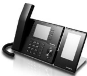
Aucune configuration n'est requise, le module d'extension est prêt à fonctionner dès sa connexion. Deux Apps sont disponibles sur le module d'extension : l'App „Accueil“ comporte 2 pages de 16 touches de fonction programmables chacune et l'App „Favoris“. En tapant Paramètres, Favoris, Affichage, on peut spécifier quelle liste de favoris sera affichée sur quel appareil. Le fonctionnement des Apps sur le module d'extension, correspond à celui des Apps sur le téléphone.
