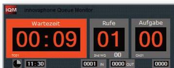
Se la soglia di allarme predefinito è stata superata, si ha o una segnalazione ottica permanente di allarme, che deve essere resettata manualmente, o un allarme acustico che può essere configurato personalmente. Un ulteriore contatore indica quante volte il valore limite è stato superato e quando si è verificato l'ultimo allarme. Analisi di avvertimento ed anche di superamento dei valori limite possono essere facilmente inviate via email alla postazione competente, ad esempio al supervisore.
